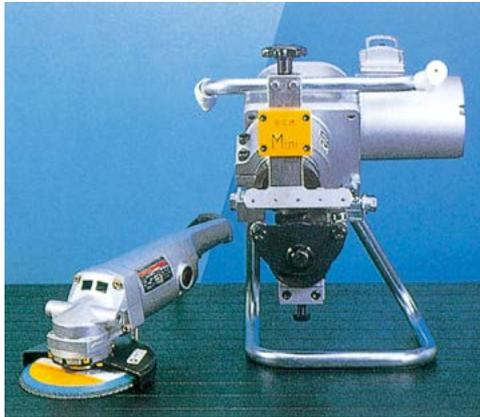
●BCM-miniシリーズは加工する鋼板の材質は選びません。鉄はもちろん、ステンレス鋼板、高張力鋼、アルミ、チタン、あらゆる材質に対応できます。
