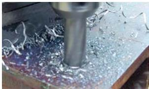
\*1 IS-LB30SXで板厚12~35mmの材料に穴あけの際、センターピンはCP-35D1を使用してください。
